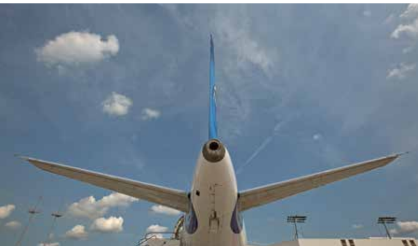
Das APU kann Flugzeuge während der Abfertigung mit Strom und klimatisierter Luft versorgen, ist aber auch eine Quelle für Lärm und Luftschadstoffe
