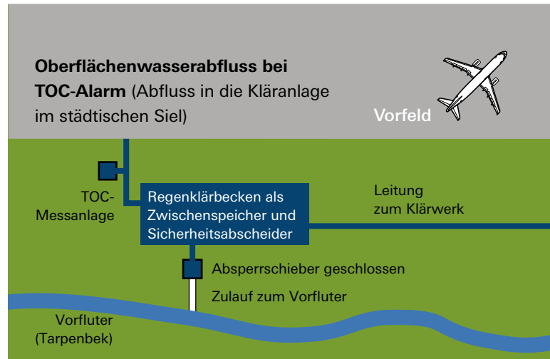
Funktionsprinzip der TOC-Anlage und des darüber gesteuerten Schiebersystems zum Schutz der Tarpenbek vor Enteisungsmitteln
